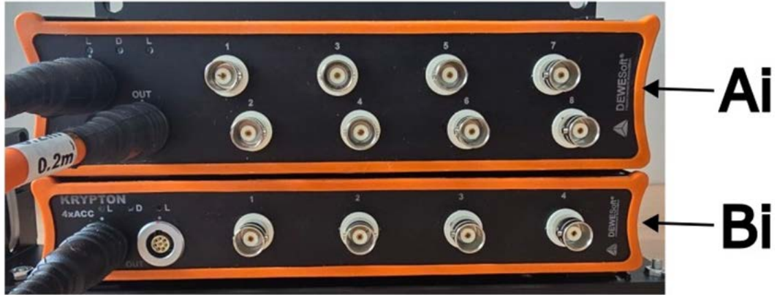
Att.5. Mērišanas bloka priekšējā paneļa fotoattēls
